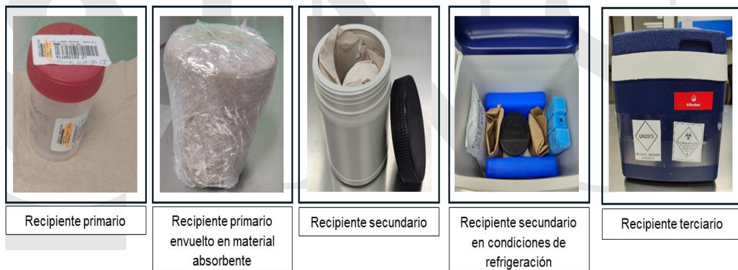
Imagen 2: Sistema triple embalaje para muestras.
